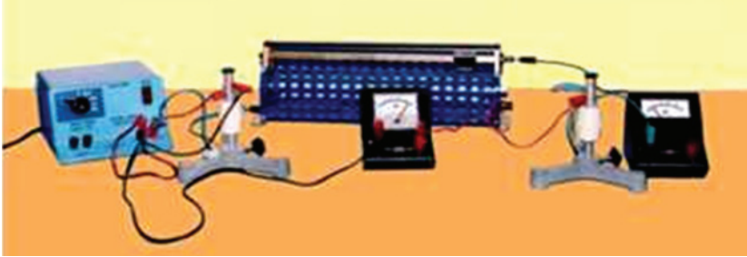
Resim 9.1 Ohm kanununa ait deney düzeneği
